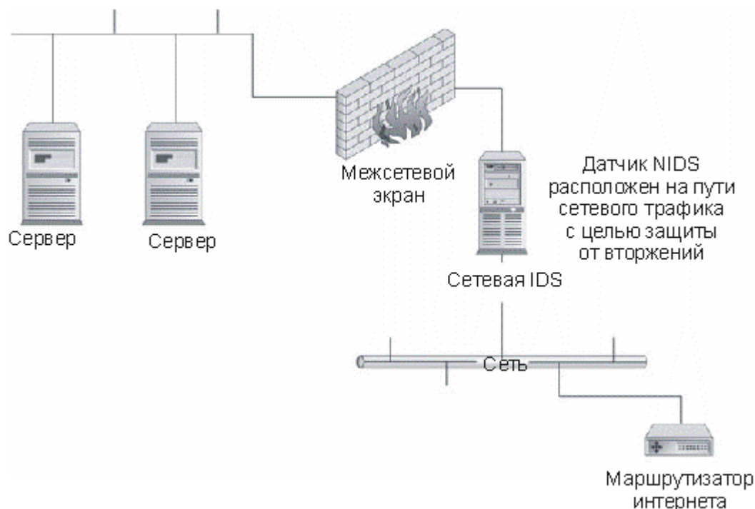
Рис. 12.5. Конфигурация, необходимая для предотвращения атак датчиком NIDS
