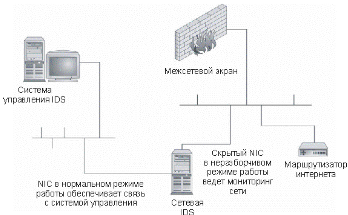
Рис. 12.2. Конфигурация NIDS с двумя сетевыми картами
